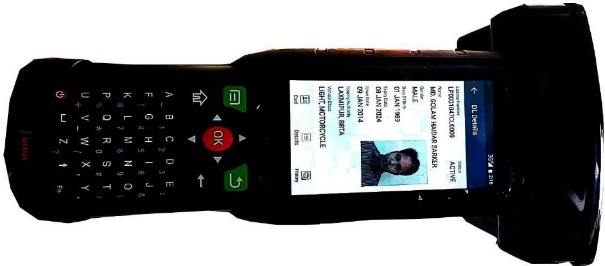
মাল্টিপারপাস হ্যান্ড-হেল্ড ডিভাইস (ডিজিটাল রেজিস্ট্রেশন সার্টিফিকেট, ড্রাইভিং লাইসেন্স এবং আরএফআইডি রিডার) এর চিত্র
