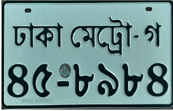
প্রাইভেট মোটরযানের রেট্রো-রিফ্লেক্টিভ নম্বরপ্লেট ও আরএফআইডি ট্যাগ
